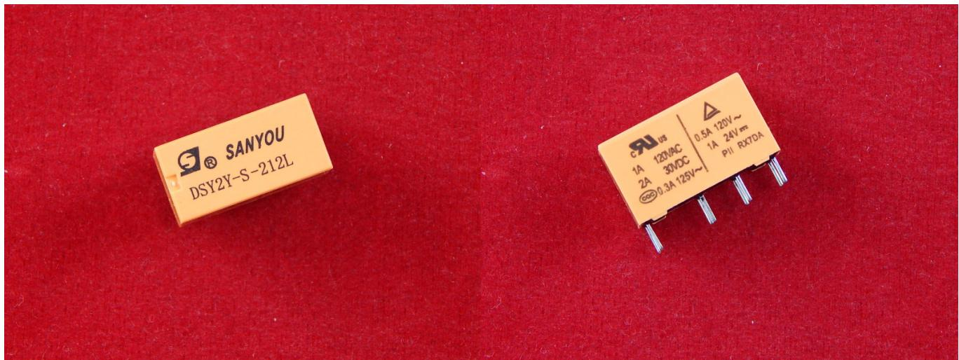
Миниатюрное электромагнитное реле DSY2Y-S-212L (12B, 1A)
