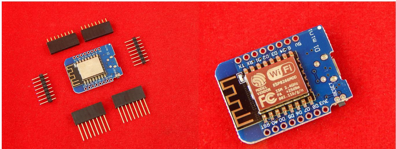
Отладочная плата WeMos D1 mini, на основе Wi-Fi модуля ESP-12F, на чипе ESP8266EX. На плате доступно 11 цифровых GPIO, аналоговый вход/выход (3.2В максимум).
