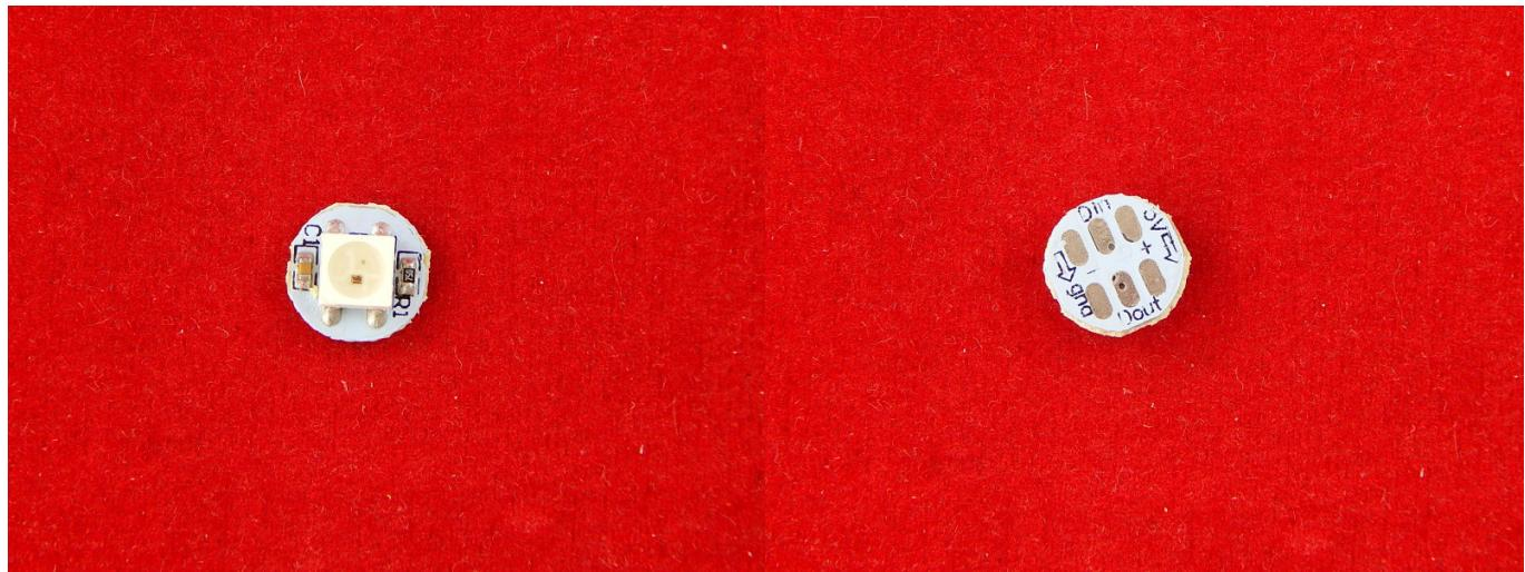
В RGB-светодиодах WS2812B встроен контроллер, осуществляющий управление цветом, яркостью и включением светодиода.
