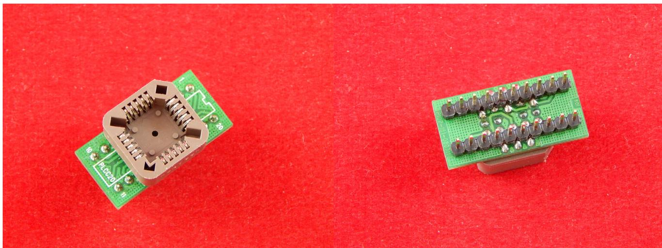
Адаптеры для программаторов (панелька для микросхем), чтобы прошивать микросхемы с различными типами корпусов
