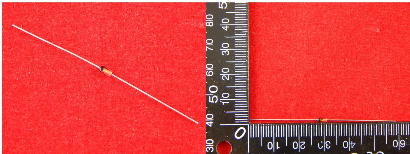
Стабилитрон это полупроводниковый диод, предназначенный для стабилизации напряжения. В отличии от обычных диодов, стабилитрон имеет достаточно низкое напряжение пробоя (при обратном включении) и что самое главное - может поддерживать это напряжение на постоянном уровне при значительном изменении силы обратного тока. Благодаря этому эффекту стабилитроны широко применяются в источниках питания.
