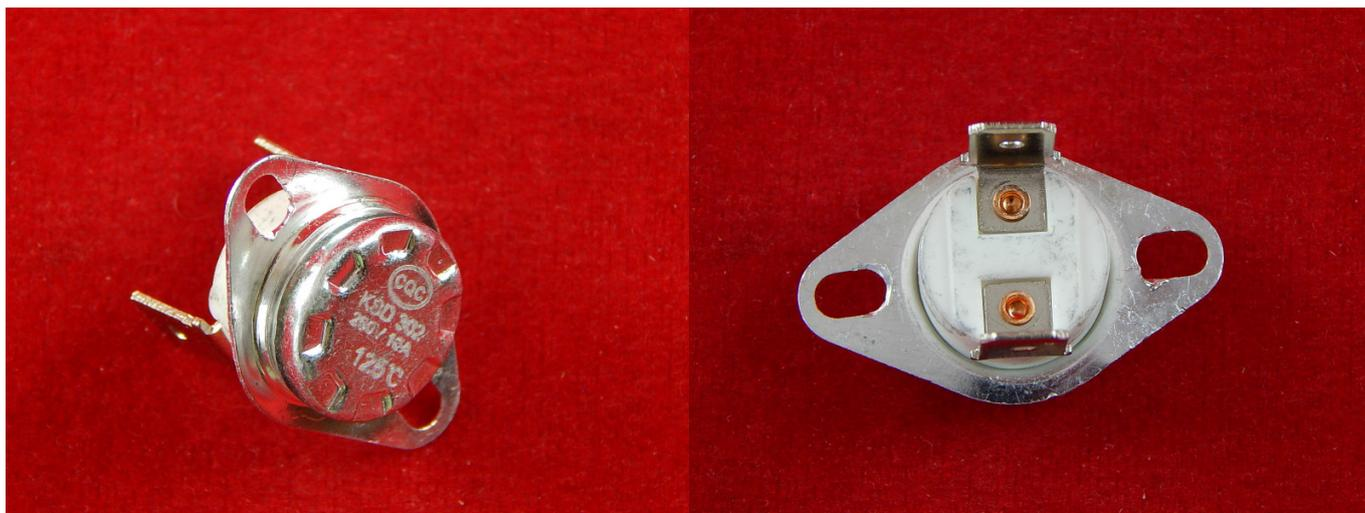
Термостаты биметаллические нормально замкнутые с температурой срабатывания от +20 до +180 градусов Цельсия. Используется в бытовой технике для экстренного отключения при перегреве. При остывании возвращается в первоначальное состояние.
