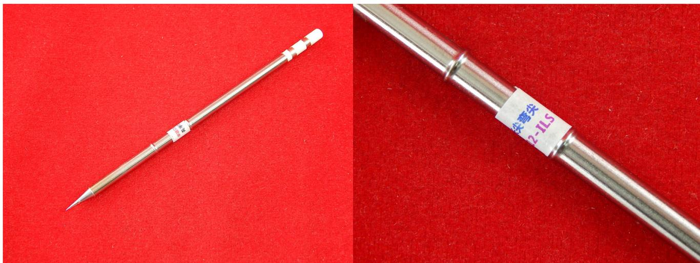
Жало с очень тонким наконечником, чем-то напоминает шило. Годится для работы в условиях очень плотного монтажа и для пайки очень маленьких SMD-компонентов (типоразмера 0603, 0402). Другие работы проводить им тяжело.
