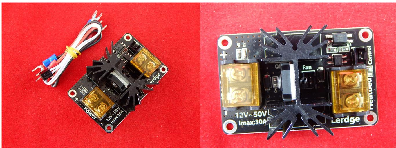
Модуль Lerdge используется для управления питанием нагревательной платформы 3D-принтера. Эта плата позволяет подключать к принтеру столы с большой мощностью (больше 150 Вт).
