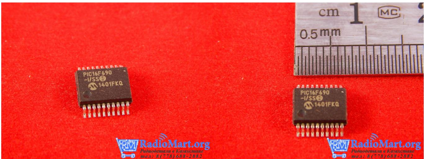
PIC16F690-I/SS 8-битный микроконтроллер в SSOP-20 корпусе
