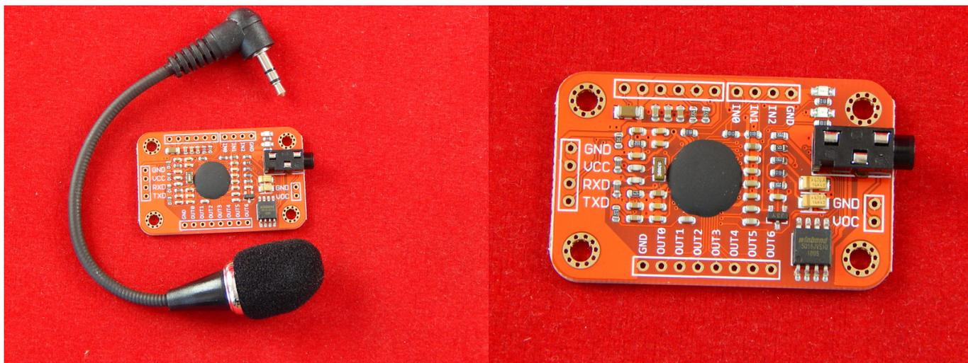
Модуль распознавания голоса Voice Recognition Module V3 представляет собой компактный и легкий контроль над управлением различными устройствами с помощью голосовых команд.
