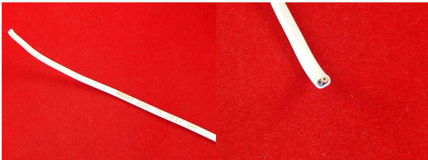
Соединительный со скрученными медными жилами, с ПВХ изоляцией, с ПВХ оболочкой, гибкие. Кабель ШВВП предназначен для присоединения машин и приборов бытового и аналогичного применения к сетям номинальным переменным напряжением до 450 В для систем 450/750 В.
