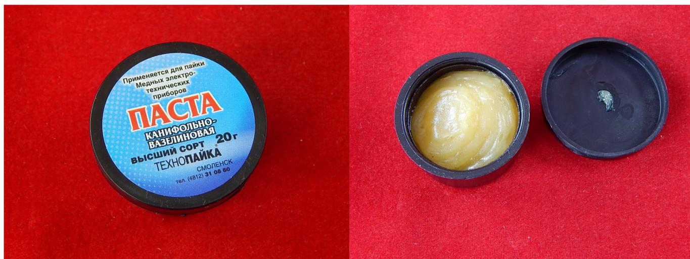
Применяется для пайки медных деталей электротехнических приборов. Температурный интервал активности: 150-300С. Состав: вазелин, канифоль, глицерин, хлористый цинк, парафин.
