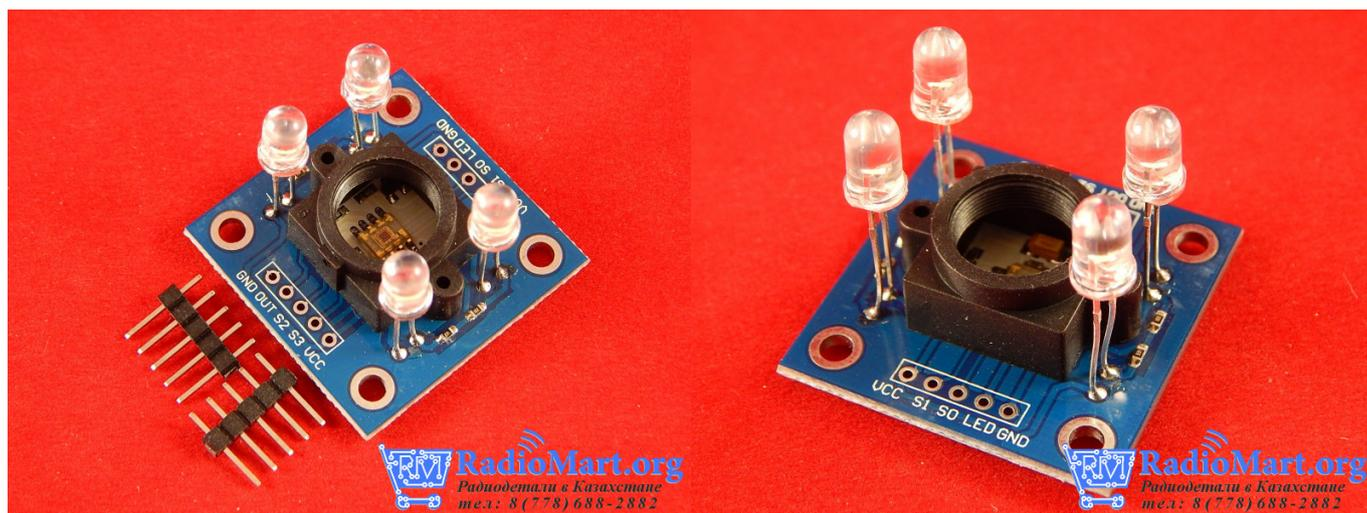
Сенсор оттенка цвета, выполненный на базе датчика TCS3200 позволяет распознать оттенок цвета объекта, расположенного перед ним или цвет окружающего освещения.
