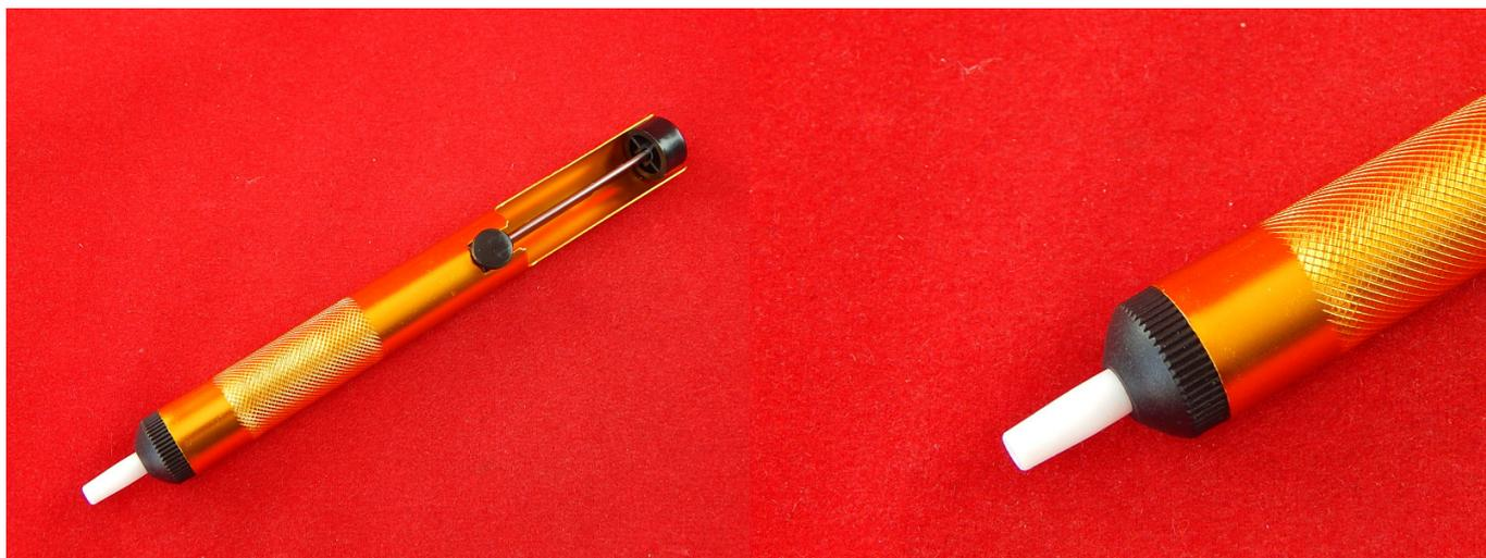
Оловоотсос для удаления растопленного припоя в использовании достаточно удобен, благодаря автомат-срабатыванию, при надавливании на колпак фиксатора, штока с поршнем, которые автоматически затягивают припой в шприц.
