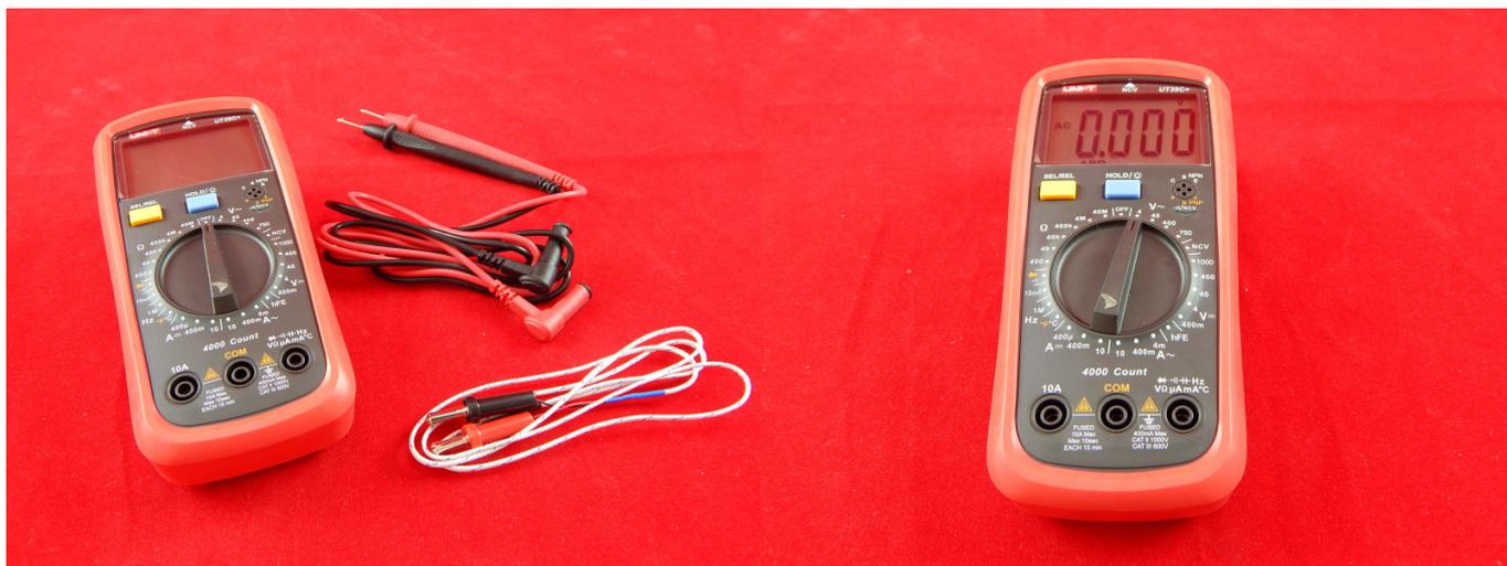
Цифровые мультиметры моделей UT-39C+ являются современными ручными измерительными приборами с 3 ½ разрядным ЖК дисплеем и защитой от перегрузки на всех пределах. Метод измерения - АЦП двойного интегрирования.
