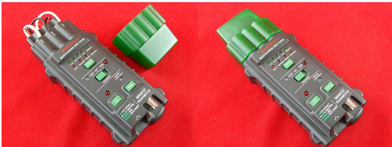
Данный прибор является ручным тестером сетевых кабелей и идеально подходит для прокладки, тестирования, обслуживания и осмотра коаксиальных кабелей (BNC), неэкранированных (UTP) и экранированных (STP) витых пар. Прибор также позволяет быстро и удобно тестировать режимы работы телефонных линий и сильно упрощает их прокладку и обслуживание
