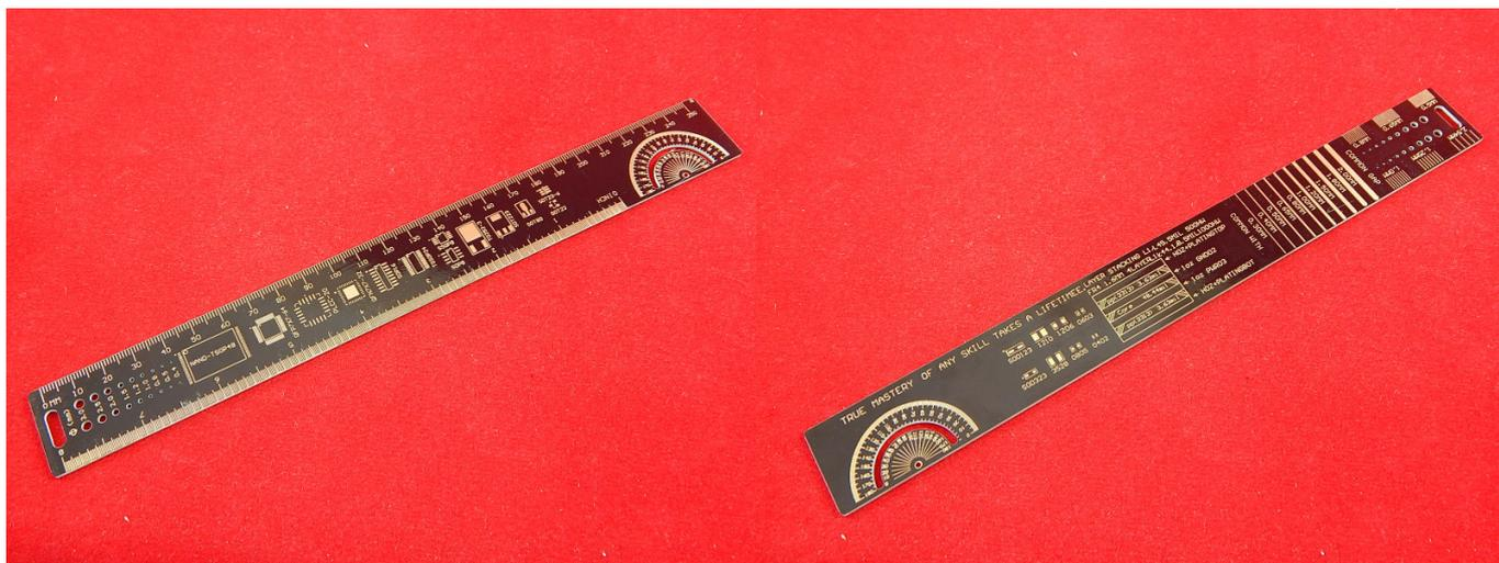
Многие помнят со школьной скамьи полезные линейки для различных предметов, на сторонах которых были написаны нужные формулы и важные значения. Теперь такая линейка доступна к покупке и электронщикам, которым она точно пригодится в их работе над проектами. Линейка электронщика для определения посадочных мест микросхем.
