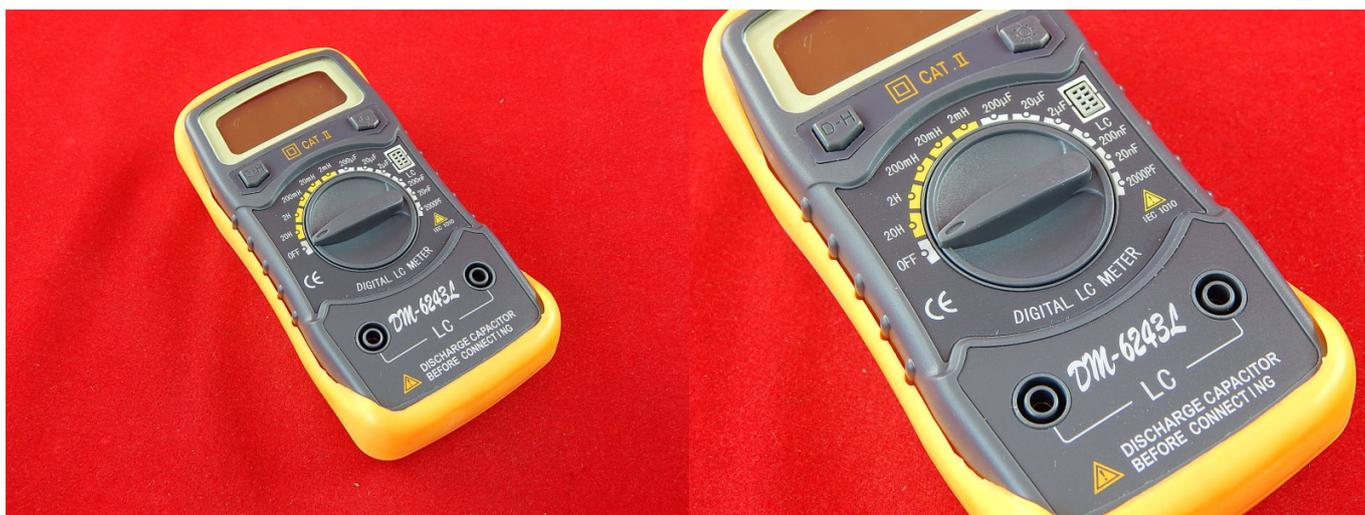
Мультиметр DM6243 - это цифровой измерительный прибор выполняющий функции высокоточного измерения емкости и индуктивности.
