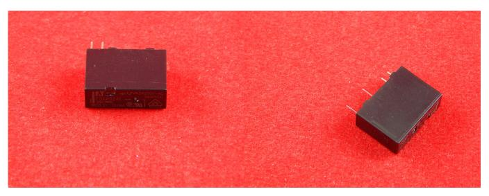
F3AA024E, Реле электромеханическое
