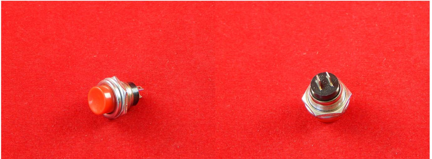
Кнопка АВ6-М OFF-(ON), 125В, 3А, без фиксации, гайка снизу, красная
