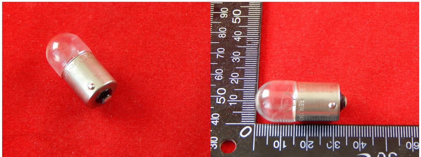
Галогенная автомобильная лампа с цоколем R5W общей мощностью 5 Ватт.
