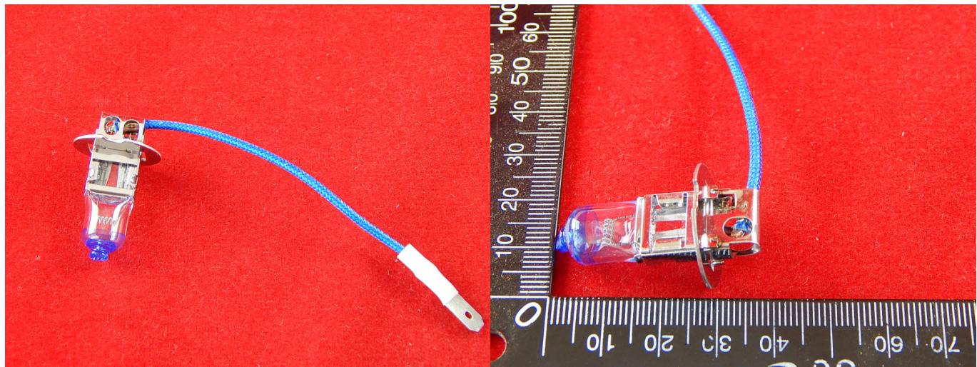
Галогенная автомобильная лампа с цоколем Н3 общей мощностью 70 Ватт.
