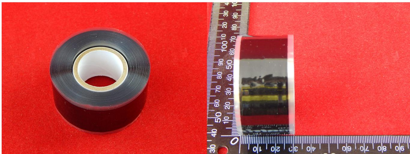
Прочная прорезиненная водонепроницаемая лента создает эластичный барьер и отталкивает воду, мгновенно останавливает протечки. При отсутствии напора/давления воды хватает 1-2 слоев ленты. При напоре/давлении воды необходимо 3-5 слоев ленты. Водонепроницаемая лента, устойчива к высоким и низким температурам. Подходит как для металлических труб так и для пластиковых труб ПВХ.
