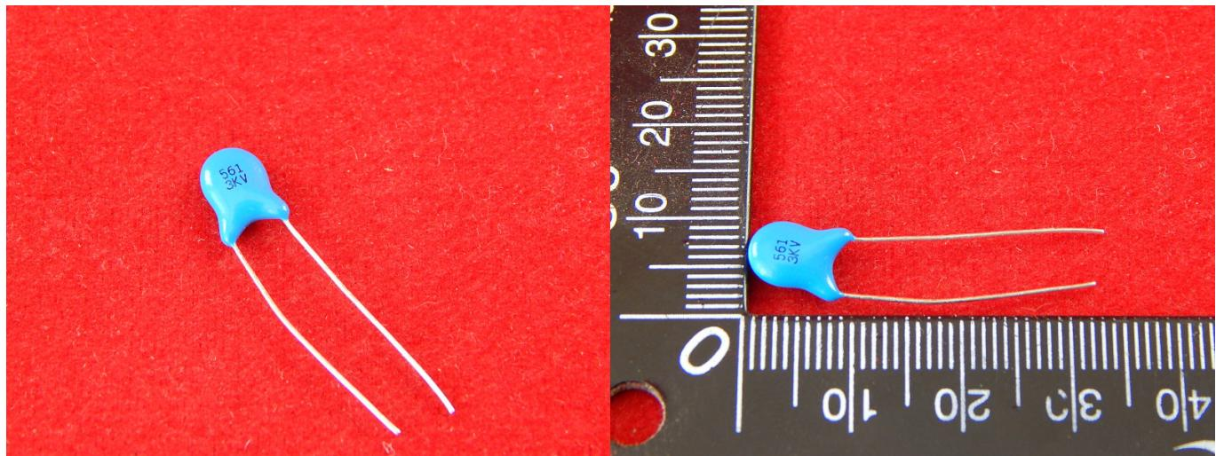
Постоянные конденсаторы, использующие керамический материал в качестве диэлектрика.
