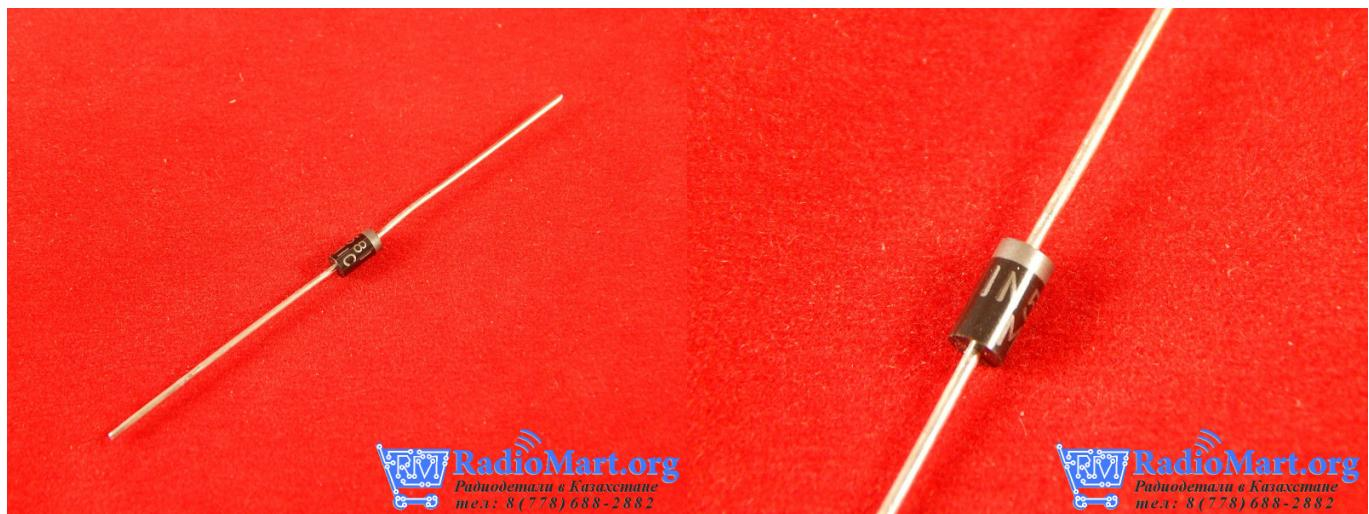
1N5819, IN5819 - Диод Шоттки с максимальным током в 1 Ампер и максимальным напряжением в 40 Вольт
