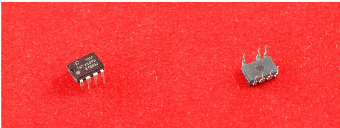
Импульсный преобразователь переменного тока в постоянный ток (AC/DC) 9.5W 85-265 VAC
