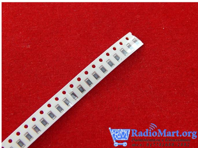
Бескорпусные толстопленочные резисторы (чип-резисторы, smd-резисторы) предназначены для работы в цепях постоянного, переменного и импульсного тока.
