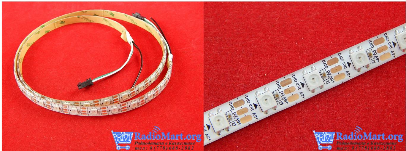
Светодиодная RGB лента с адресацией (RGB SMART-лента) на основе RGB светодиодов WS2812B в SMD корпусе 5050. SMART-лента отличается от обычных светодиодных RGB лент тем, что каждым светодиодом в её составе можно управлять отдельно от остальных. То есть можно, например зажечь часть светодиодов синим светом, часть - зеленым, часть - белым, некоторые вообще выключить и т.д.
