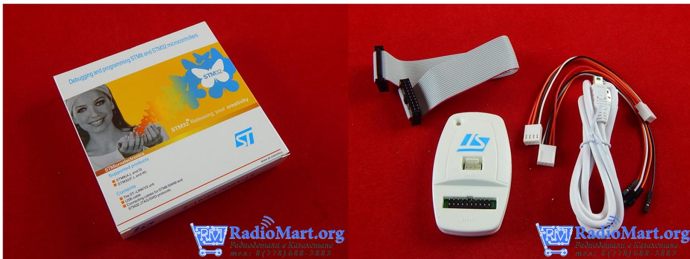
ST-LINK/V2 – внутрисхемный программатор/отладчик для микроконтроллеров серии STM8 и STM32 производства фирмы STMicroelectronics. Отладчик подключается к отладочным платам посредством стандартного JTAG/SWD интерфейса (микроконтроллеры на базе ядра STM32) или посредством SWIM-интерфейса (для микроконтроллеров семейства STM8).
