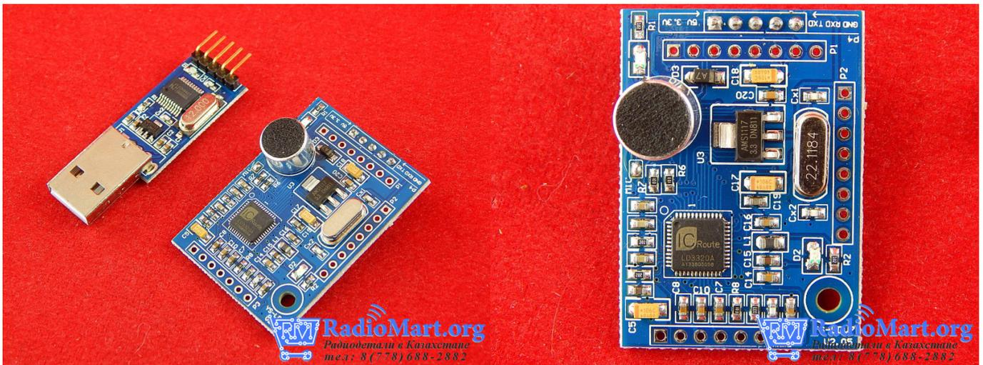
Данный модуль основанный на чипе LD3320 позволяет создать систему распознавания речи. Позволяем управлять различными устройствами голосовыми командами.
