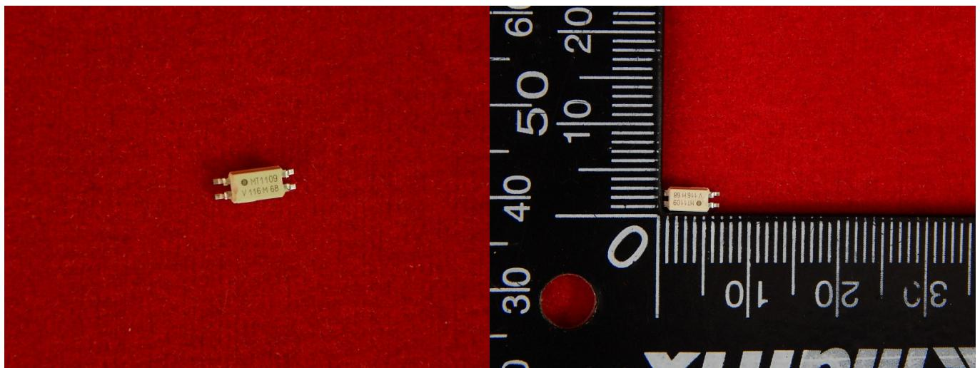
Оптопара с транзистором на выходе. 1 канал, SOP, 4 вывод(-ов), 60 мА, 3.75 кВ, 200 %.
