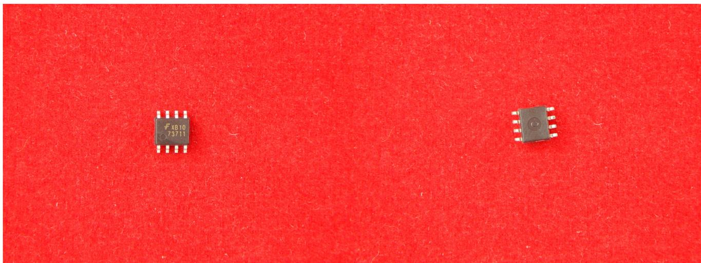
FAN73711 - Сильноточная управляющая ИС затвора с высокой стороны, SOP-8.
