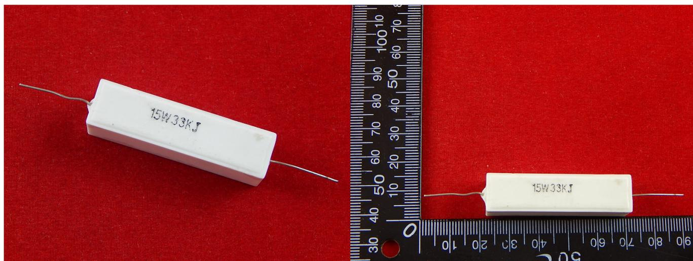
Резисторы керамические проволочные цементные – постоянные резисторы, номинальное сопротивление составляет 33 кОм, рассеиваемая мощность – 15Вт. Предназначены для эксплуатации в цепях постоянного или переменного тока, обеспечивая ограничение силы тока и распределение напряжения. Монолитная керамическая конструкция обладает: огнестойкостью, влагостойкостью и способностью к самозатуханию.
