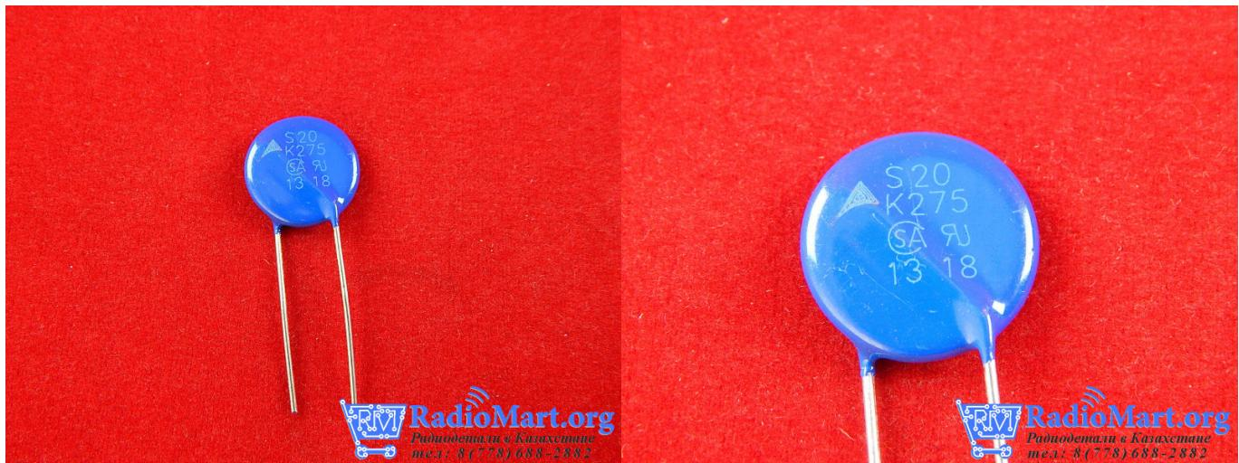
Металлоксидные дисковые варисторы SIOV представляют собой нелинейные резисторы с симметричной вольтамперной характеристикой. Варисторы обеспечивают защиту от всех видов пренапряжения и предотвращают выход электрического оборудования из строя.
