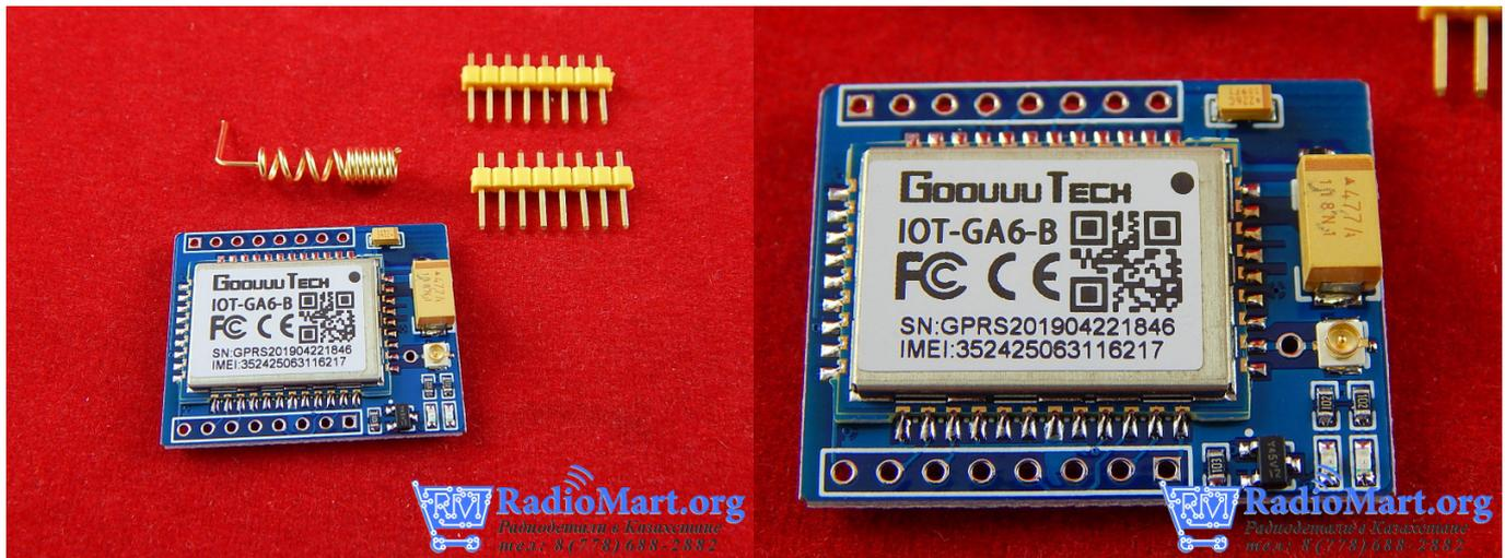
Модуль A6 GPRS/GSM разработан фирмой AI-THINKER в 2016 году. Устройство используется для обмена смс-сообщениями и обмена данными по GPRS. Плата отличается низким потреблением энергии и малыми размерами. Goouuu Tech IoT GA6 - GSM/GPRS - клон модуля A6 от AiThinker. На плате модуль имеет всю необходимую для работы обвязку и включает слот установки SIM карты.
