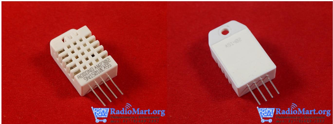
Датчик DHT22 состоит из емкостного датчика влажности и термистора. Также, датчик содержит в себе простенький АЦП для преобразования аналоговых значений влажности и температуры. Является более точным датчиком чем DHT11.
