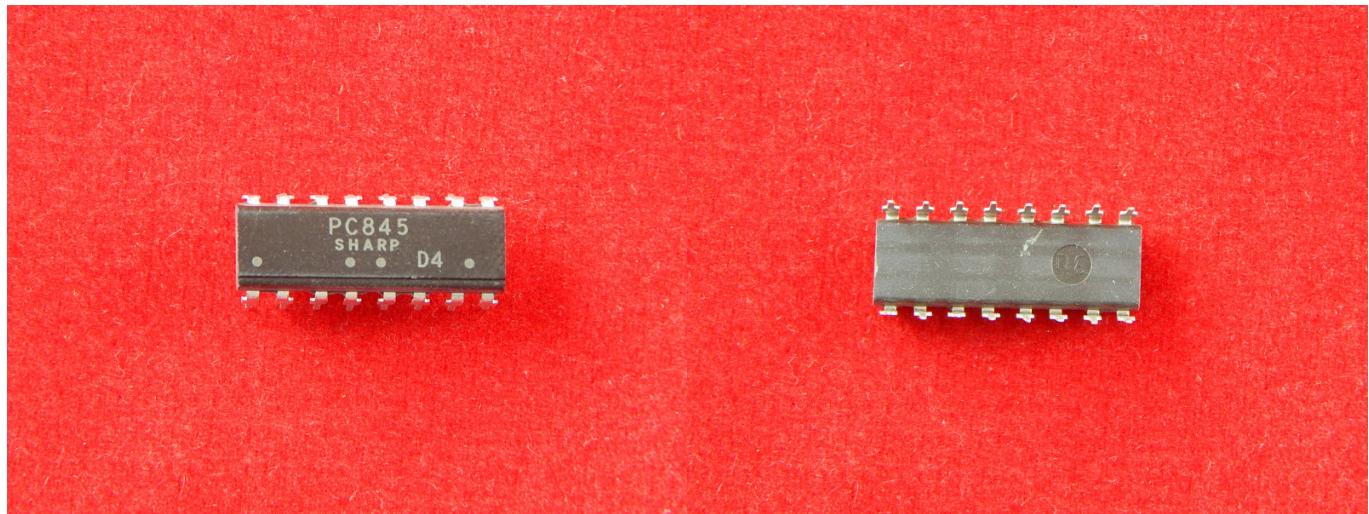
Оптрон — электронный прибор, состоящий из излучателя света. Принцип работы оптрана заключается в преобразовании электрического сигнала в свет, его передаче по оптическому каналу и последующем преобразовании обратно в электрический сигнал.
