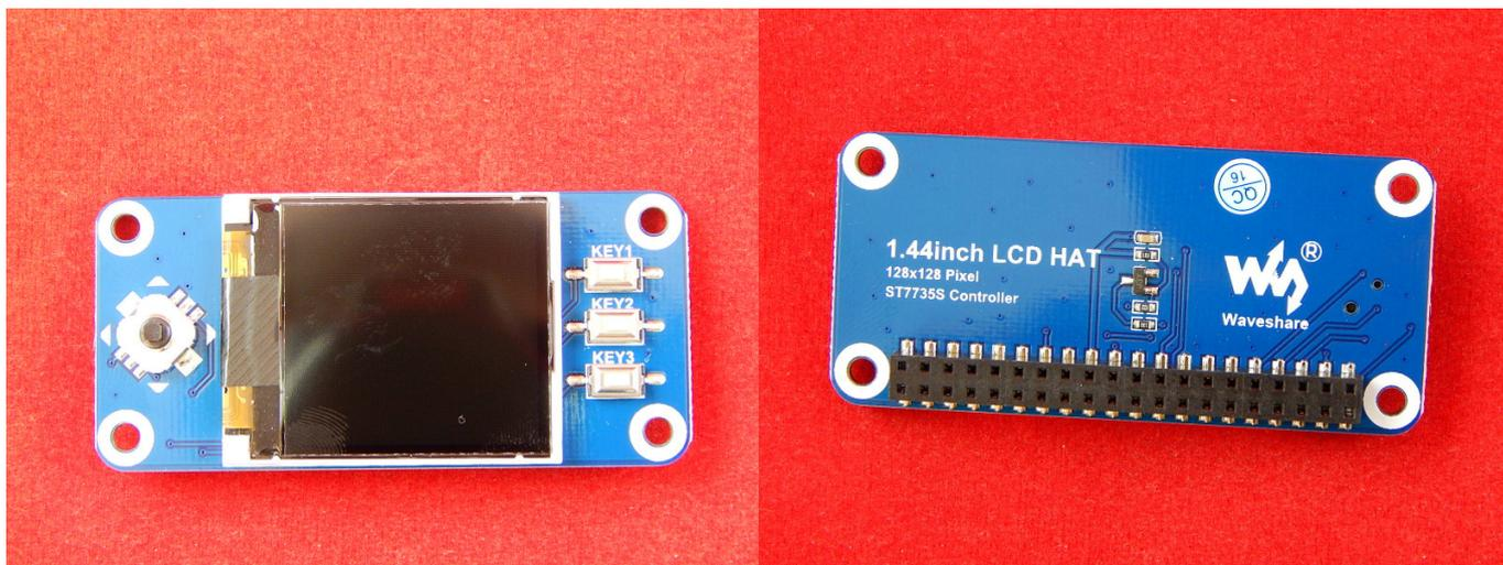
1,44-дюймовая ЖК-плата расширения Raspberry Pi с разрешением 128x128, с внутренним контроллером, который может обмениваться данными через интерфейс SPI.
