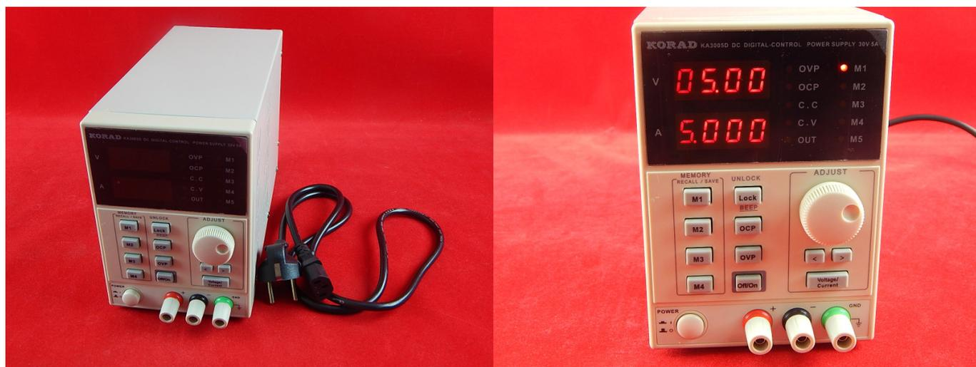
KA3005D фирмы KORAD TECHNOLOGY представляет собой трансформаторный лабораторный блок питания с цифровым управлением, который применяют в различных сферах производства и ремонта, где необходимо получить напряжение и ток требуемого значения.
