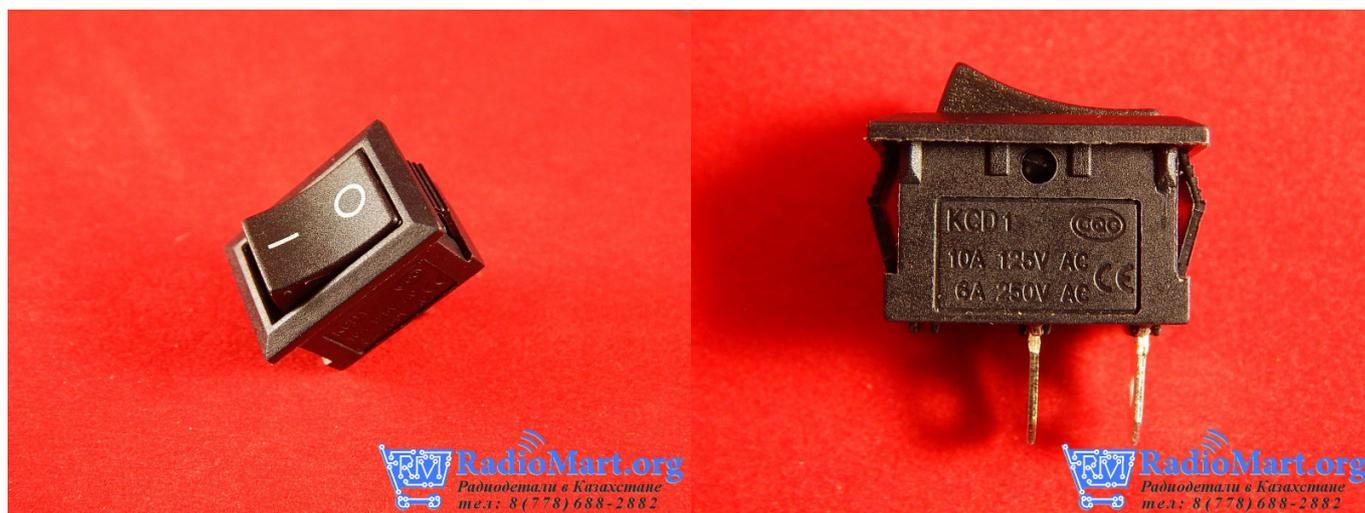
Переключатель черный 15x21 мм с режимом работы ON-OFF. Является коммутирующим элементом в различных электроцепях. KCD1 - это переключателем с однополюсной группой контактов, (1 группа - 2 контакта). Корпус изготовлен из негорючего пластика чёрного цвета. Контакты изготовлены из анодированной латуни.
