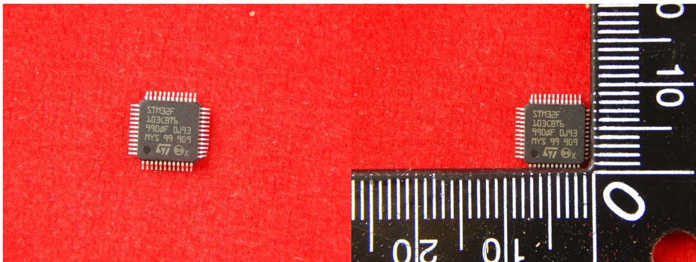
Микроконтроллер - это специальная микросхема, предназначенная для управления различными электронными устройствами. Типичный микроконтроллер сочетает на одном кристалле функции процессора и периферийных устройств, содержит ОЗУ и ПЗУ.
