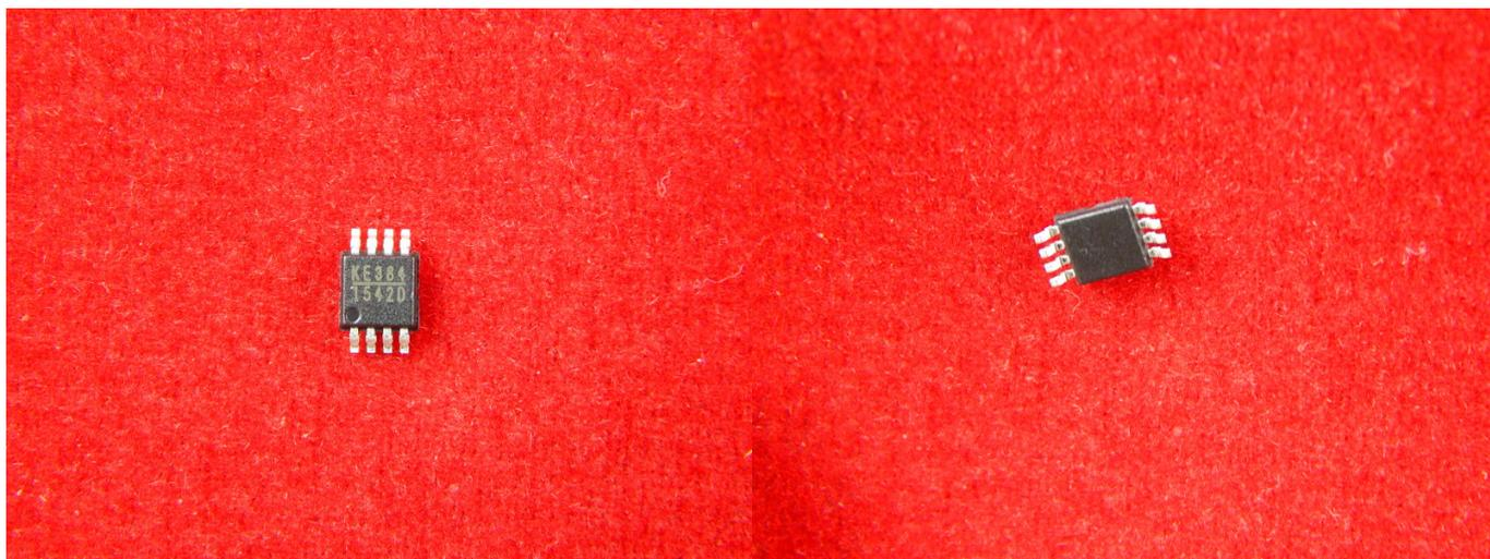
MP1542 - это повышающий преобразователь в токовом режиме с внутренним переключателем 2А, 0,18О, который обеспечивает высокоэффективный регулятор с быстрым откликом.
