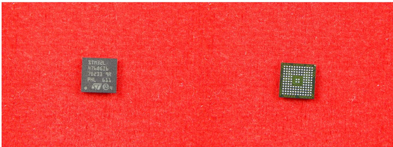
STM32L476QGI6 представляет собой сверхмалый микроконтроллер на основе высокопроизводительного 32-разрядного RISC-ядра Arm® Cortex®-M4, работающего на частоте до 80 МГц. А так же имеет несколько механизмов защиты для встроенной флэш-памяти и SRAM: защита от чтения, защита от записи, защита от чтения кода и межсетевой экран.
