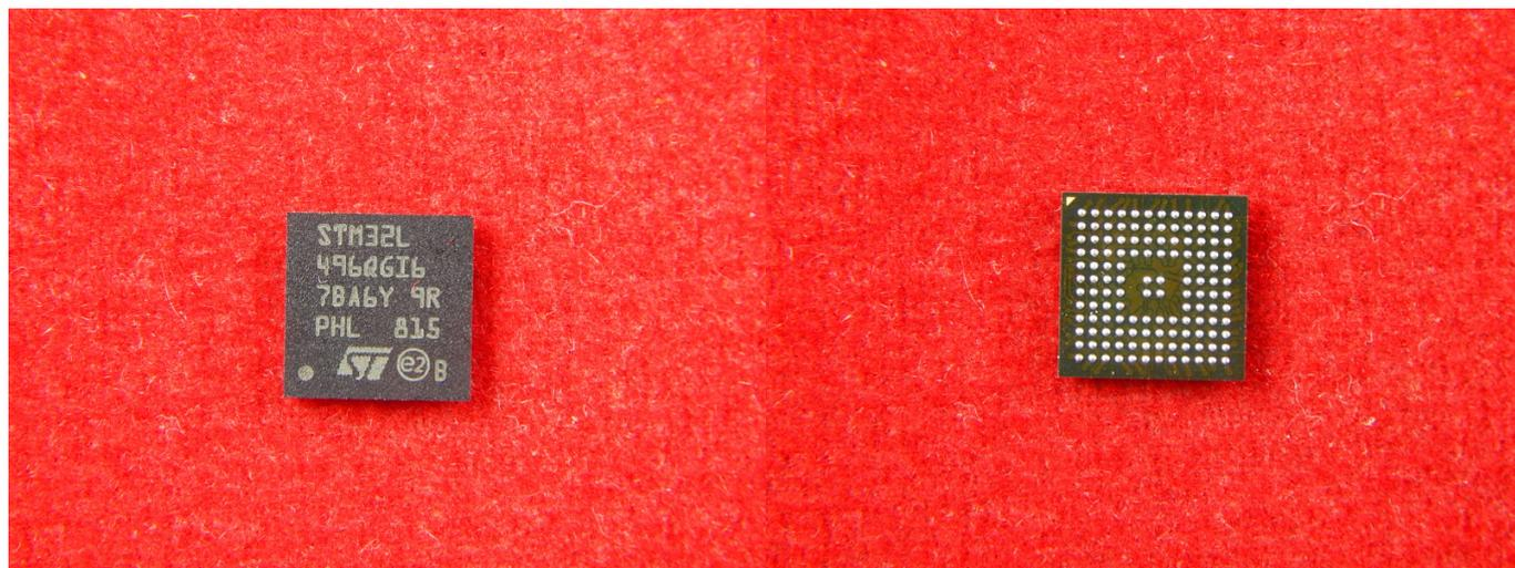
Микроконтроллер STM32L4 основан на новой сверхмощной платформе с FlexPowerControl. Это расширяет гибкость для достижения оптимального энергопотребления. STM32L4 превосходит рынок в области сверхмалого энергопотребления с показателем EEMBC ULPBench 150 ULPBench™ -CP. Он предлагает до 2 Мбайт Flash и до 640 Кбайт SRAM.
