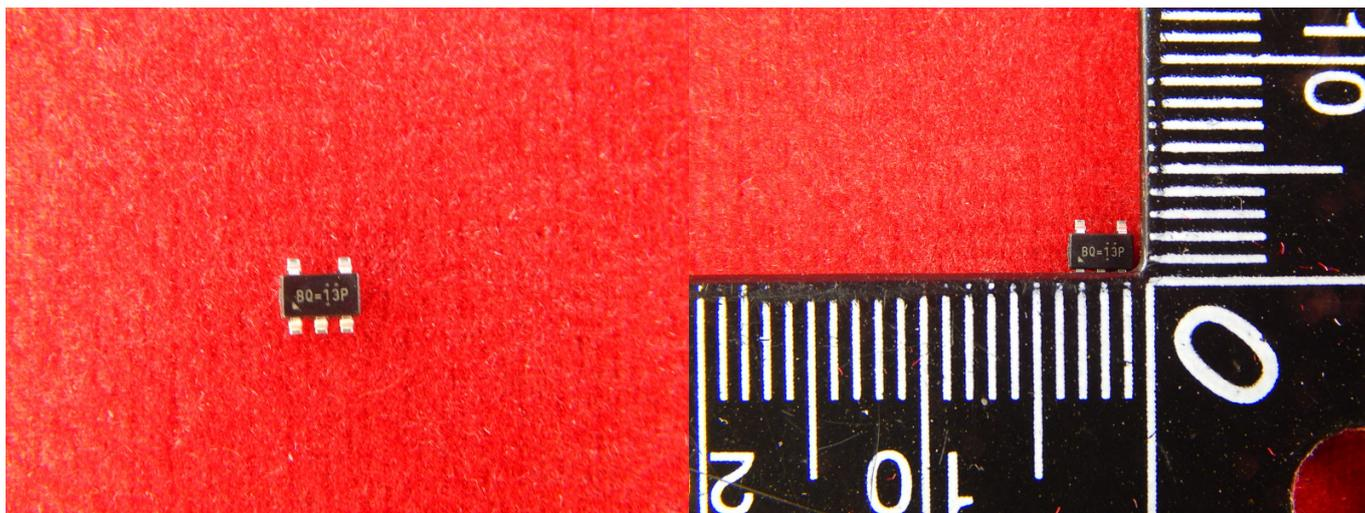
RT8059 - это высокоэффективный понижающий DC / DC-преобразователь с широтно-импульсной модуляцией, способный выдавать выходной ток 1 А в широком диапазоне входного напряжения от 2,8 до 5,5 В. RT8059 идеально подходит для портативных электронных устройств, которые питаются от 1-элементной литий-ионной батареи или других источников питания в пределах диапазона.
