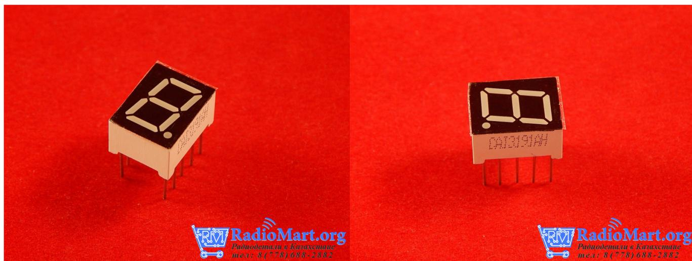
7-сегментный LED индикатор 0.39", Красный, Общий катод, состоящий из семи светодиодов, установленных в форме цифры 8. Зажигая или выключая соответствующие LED-ы (сегменты) можно отображать цифры от нуля до девяти, а так же некоторые буквы.
