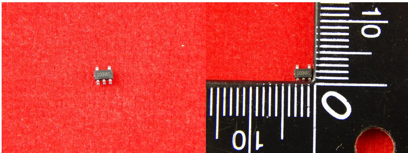
Одноканальный переключатель нагрузки с ограничением тока, предназначенный для защиты от короткого замыкания и перегрузок по току путем его ограничения до заданного уровня. Тип корпуса SOT23-5. Применяется в периферийных устройствах, ноутбуках, компьютерах, а также в планшетах и сотовых телефонах.
