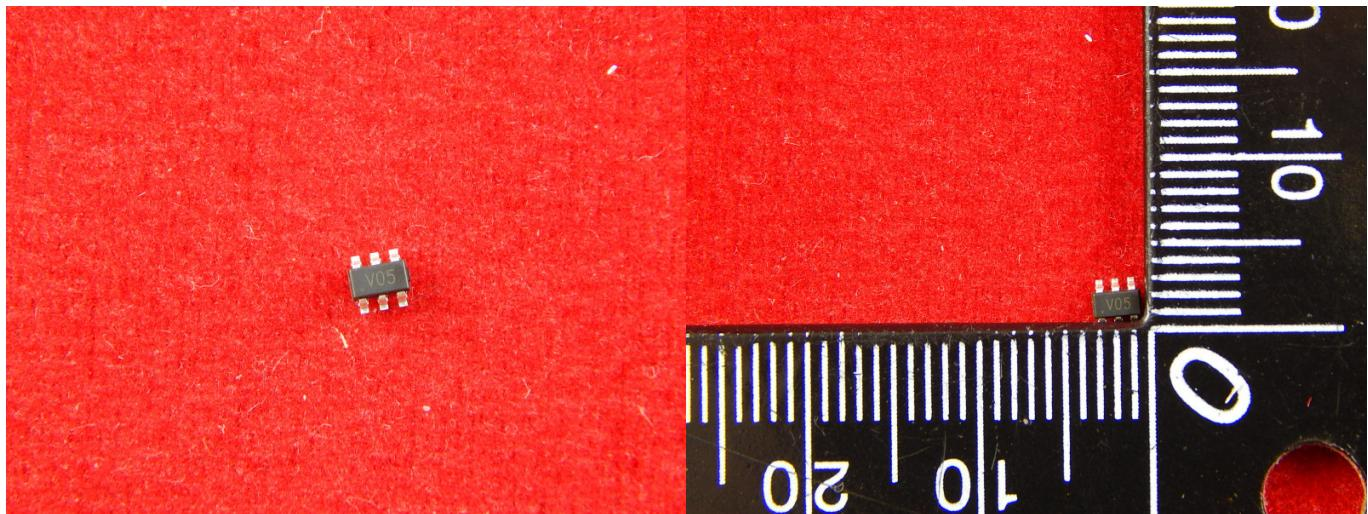
SRV05-4 - это диодная матрица с подавлением переходных процессов (TVS), рассчитанная на защиту от импульсных перенапряжений, предназначенная для защиты высокоскоростных интерфейсов данных.
