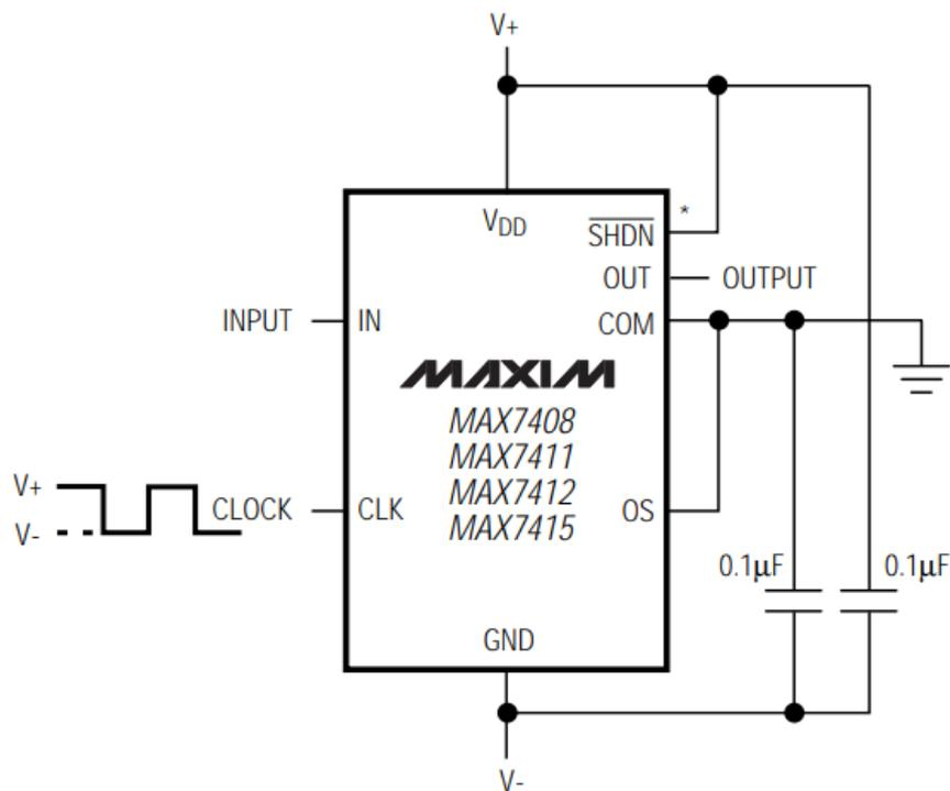
\*CONNECT  $\overline{\text{SHDN}}$  TO V<sub>-</sub> FOR LOW-POWER SHUTDOWN MODE.
