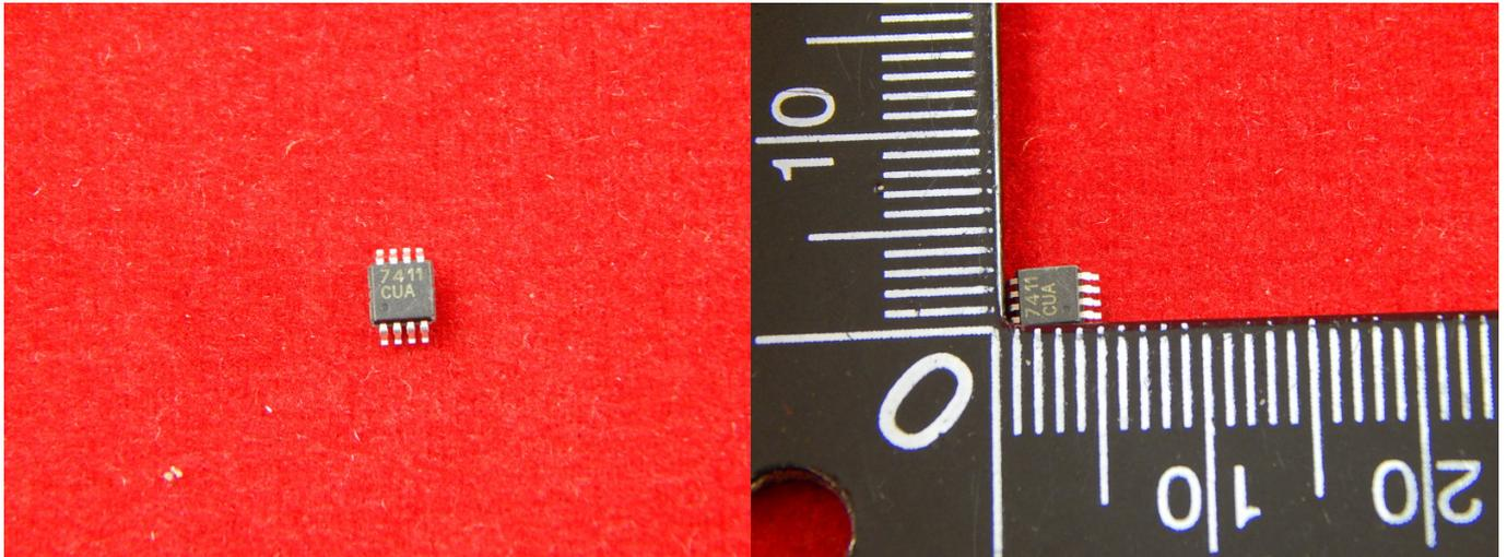
MAX741 это низкочастотный эллиптический фильтр с переключаемыми конденсаторами 5-го порядка 15 кГц 8-иMAX, работают от одного источника питания +5 В. Его можно перевести в режим пониженного энергопотребления, тем самым уменьшив ток питания до 0,2 мкА.
