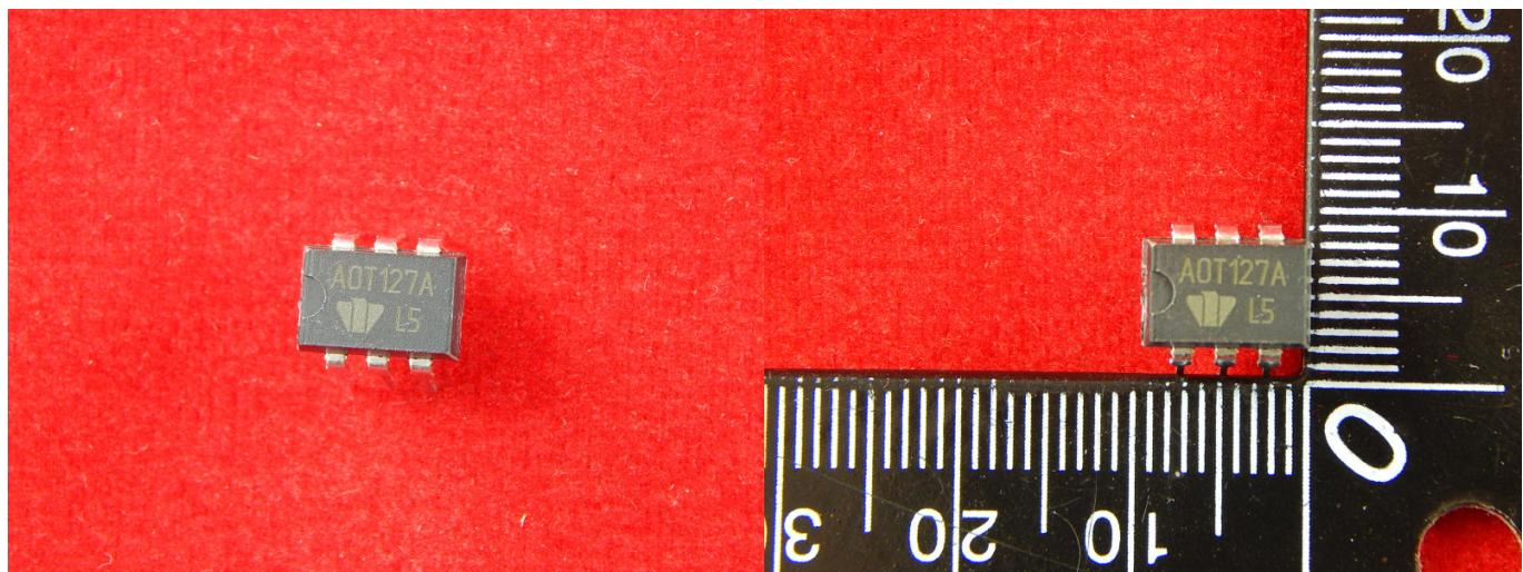
Оптрон применяется для гальванической развязки в цепях с отличными блоками, преобразования и модуляции импульсов для управления аппаратами, контроля и управления, сигнализации и защиты электрического оборудования и процессов (счетчики, коммутаторы, реле, электрические измерительные устройства).
